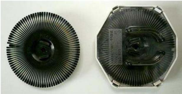
Typenscheibe für robotron S 6001
