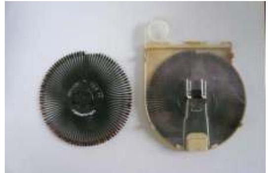
Typenscheibe für robotron S 6010//6011
