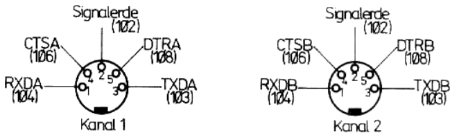
Bild 4: Blick auf die Vorderseite der Diodenbuchse
